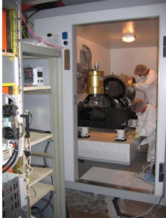
Intégration du spectrographe SOPHIE au télescope de 1,93m de l'Observatoire de Haute-Provence.
